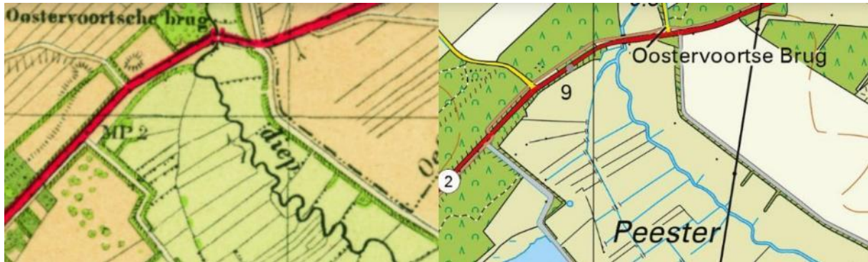
Afbeelding 10 Een deel van de Broekenloop. Links de situatie in 1900 met een sterk meanderend verloop. Rechts de situatie na de ingrepen. Bron: topotijdreis.nl
